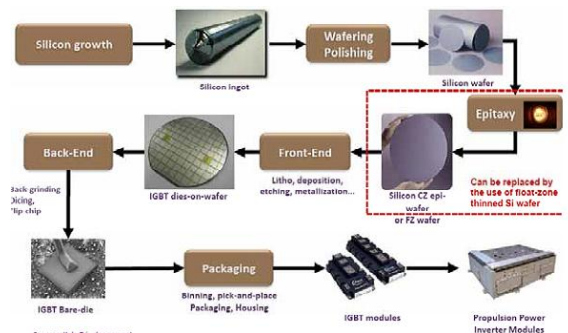
图 8: IGBT 模块的生产流程
